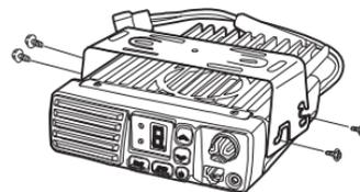
4. Определите требуемый угол наклона корпуса радиостанции и надёжно затяните крепёжные винты во избежание перемещения радиостанции от вибрации во время движения автомобиля.
